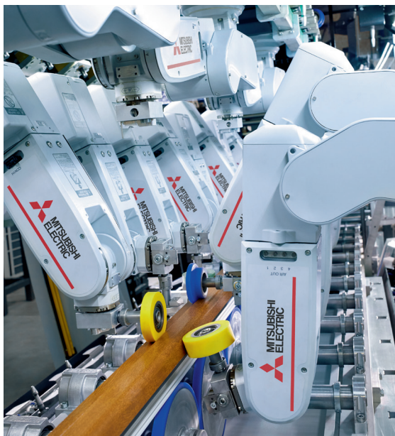
Jeder Roboter entnimmt die benötigte Rolle aus einem Kettenmagazine und nimmt die Andruckposition ein. Foto: Mitsubishi Electronic
